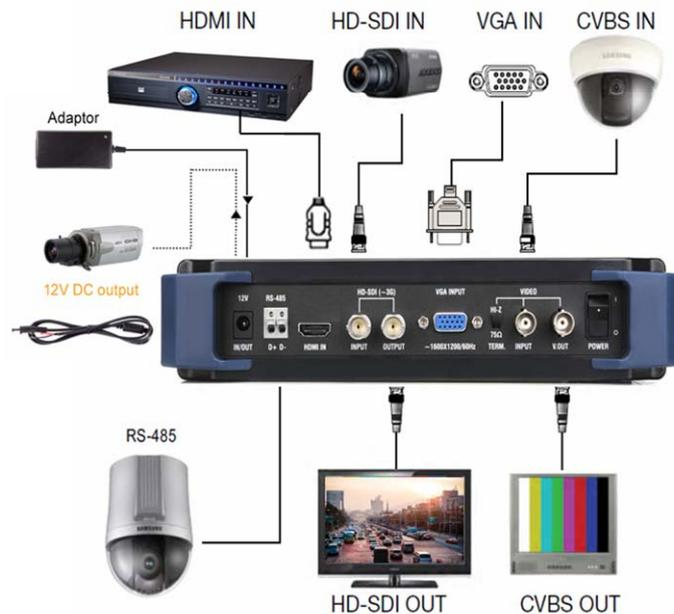
Sollten Sie eine an den Tester angeschlossene Kamera mit Strom von diesem versorgen wollen, nutzen Sie bitte das dem Gerät beiliegende Anschlusskabel!
